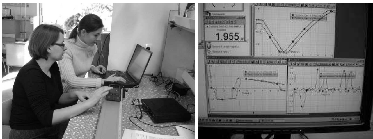
Rys. 4. System PASCO – doświadczenie z wózkami i jego wyniki pokazane w czasie rzeczywistym.
