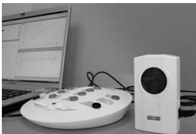
Fot. 1. Sposób połączenia konsoli pomiarowej Coach Lab II+, czujnika ruchu oraz komputera.
