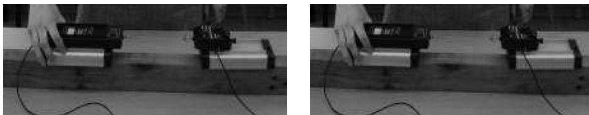
Fot. 2. Dwa wózki z podłączonymi czujnikami siły: a) połączone gumką; b) połączone sznurkiem, ciągnięte po drewnianej belce.
